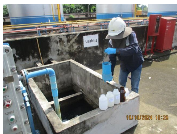
รูปที่ 3.2.1-3 วิธีการเก็บตัวอย่างน้ำทิ้งจากบ่อบำบัดหมายเลข 4
