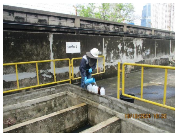
รูปที่ 3.2.1-2 วิธีการเก็บตัวอย่างน้ำทิ้งจากบ่อบำบัดหมายเลข 2
